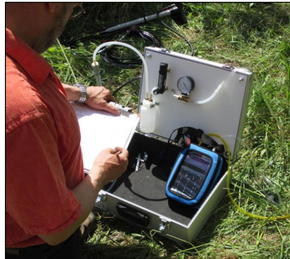
Bild 3: Vor-Ort-Messung im Bereich einer Deponiealtlast auf Methan, Kohlendioxid, Sauerstoff und Schwefelwasserstoff
