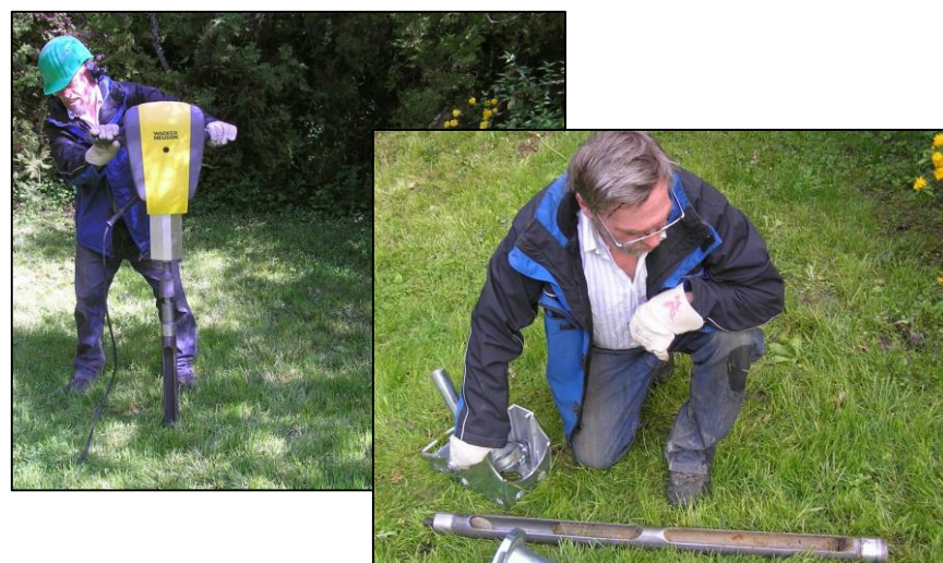
Bild 2: Rammkernsondierung und Bodenbeurteilung
