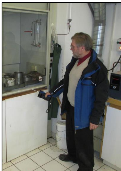
Bild 1: MAK-Wert-Messung mit direkt anzeigenden Prüfröhrchen in einem Labor
