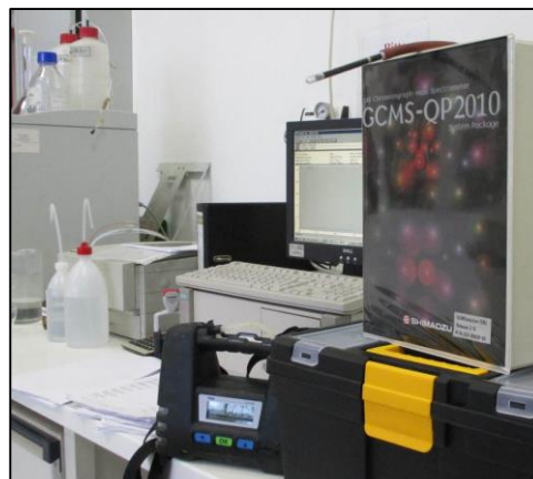
Bild 2: Schadstoff-Anreicherung auf Aktivkohle für eine Halbstundenmittelwert-Bestimmung
