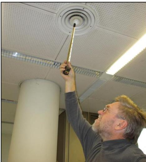
Bild 1: Messung der Luftgeschwindigkeit
