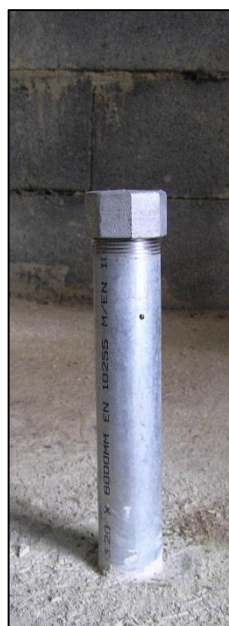
Bild 2 und 3: Stationäre Bodenluftsonden DM 5/4-Zoll mit Schraubkappe bzw. Kugelhahn-Abschluss
