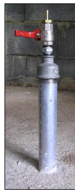
Bild 2 und 3: Stationäre Bodenluftsonden DM 5/4-Zoll mit Schraubkappe bzw. Kugelhahn-Abschluss
